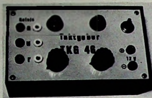
Bild 1. Taktgeber mit einstellbarer Impuls- und Periodendauer
